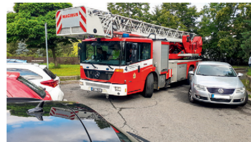
Tento hasičský speciál na podvozku Econic má výhodu velkého „rejdu.“
