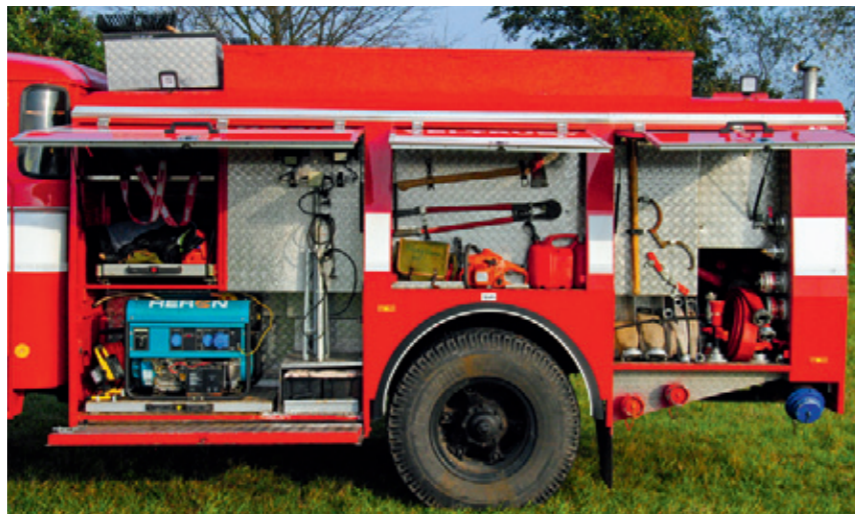
Repasováním nástavby, byl vytvořen prostor, pro další skříňě po obou stranách vozidla.
