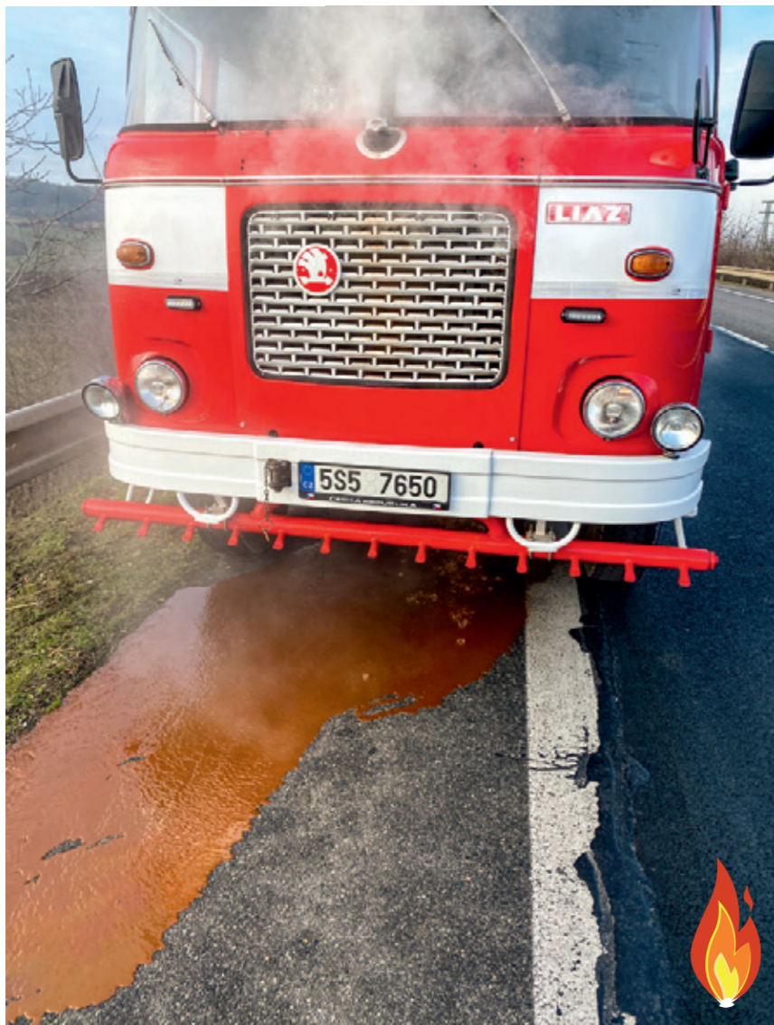
Prasklá součástka motoru, měla za následek, únik chladicí kapaliny a uvedení vozidla mimo výjezd.
