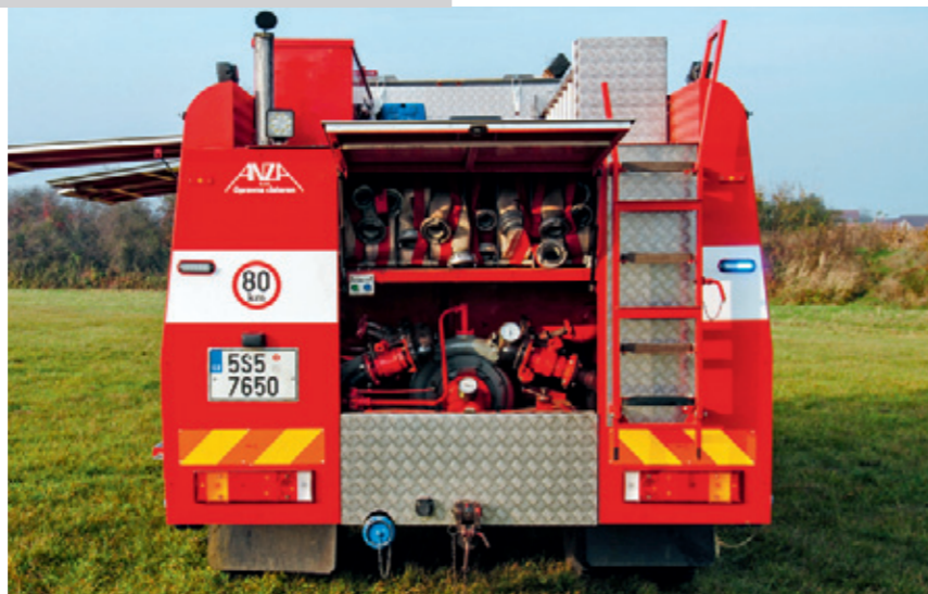
Volný prostor po odstranění nádrže na pěnidlo, využili pro uložení více hadic.
