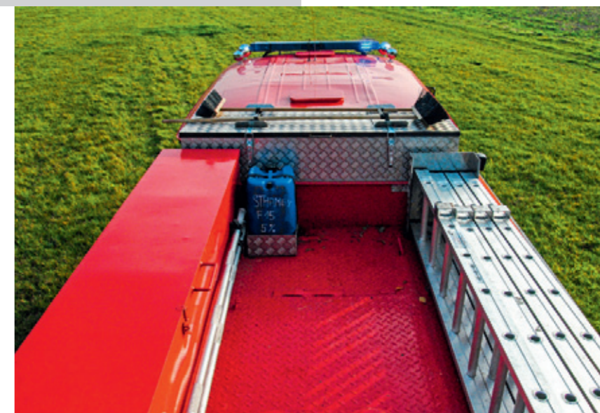
Odstraněním lafetové proudnice, získali možnost instalace nových úložných prostor.
